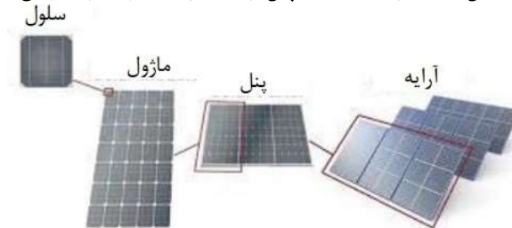
شکل ۱: سلول، ماژول، پنل (صفحه) و آرایه خورشیدی
